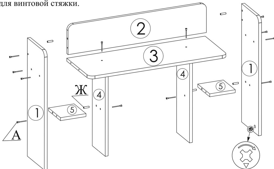
1.1. В отверстия в боковых стенках (дет. № 1) вставьте эксцентрики. Стрелка на эксцентрике должна быть направлена вниз.
