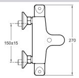
Спецификация продукта: Настенный термостатический смеситель ванна/душ. E75772. Коллекция: ROBUST. Тип установки: Крепление к стене. Нормы и правила: NF: I\*/S - E3/1 C3 A2 U3 (Ge5) - ACS: 15 ACC LY 578. Расход воды: 20. Расстояние между центром излива и центральной осью корпуса: 145 - 158 мм. Подключение: С соединителями и настенными крепежами. Разметка отверстий: 150 +/- 15 мм. Настенный термостатический смеситель.. Встроенный автоматический переключатель..
