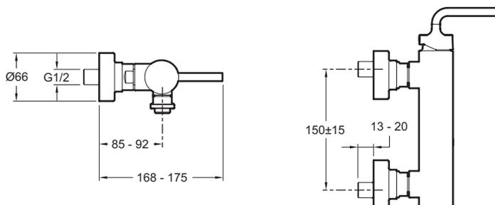
Спецификация продукта: Настенный смеситель для душа. E14590-4A. Коллекция: PURIST. Вес: 3,1 кг. Расход воды: 14 л/мин при давлении 3 бар. Механизм: Последовательный керамический картридж. Разметка отверстий:  $150 \pm 15$  мм.
