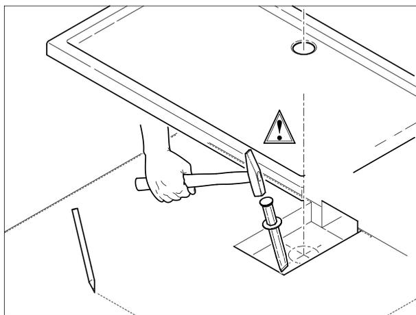
**1.** Перед началом монтажа необходимо сделать разметку расположения сифона через отверстие в поддоне для него. Ориентируясь на отметку, необходимо сделать углубление в полу для нижней части сифона. Величина углубления зависит от размеров сифона. Место установки поддона Tasos должно быть плоским, горизонтальным, стабильным, без трещин. При угловом монтаже, следует иметь ввиду что стены по отношению к друг другу должны иметь угол 90 градусов.
