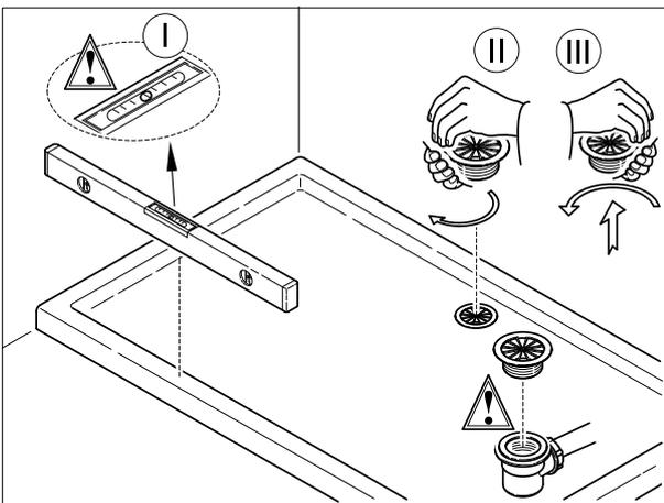
**7.** Обеспечить горизонтальное расположение поддона, используя при этом длинный уровень.
