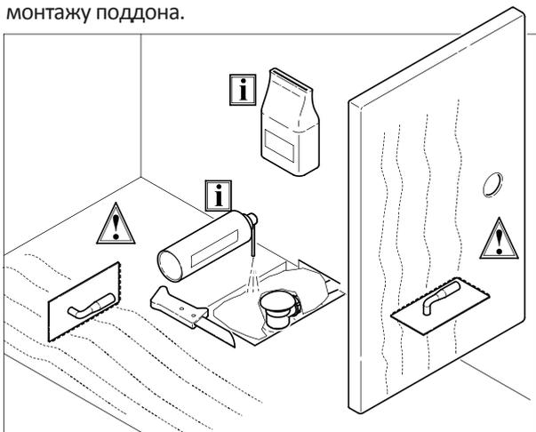
**5.** Углубление под сифон необходимо заполнить монтажной пеной, избыток пены необходимо удалить ножом. Следующим шагом является нанесение клея на пол и на нижнюю часть поддона.
