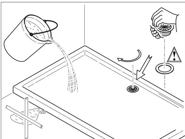
**3.** Подсоединив сифон к трубе, необходимо приложить поддон на место его установки. Соединить верхнюю часть сифона с нижней. Герметичность соединений и правильность расположения поддона с учетом уклонов на нем можно проверить посредством выливания небольшого количества воды на установленный поддон. Если вода с поддона стекает равномерно в сифон и нет следов подтекания воды, то можно приступать к окончательному монтажу поддона.
