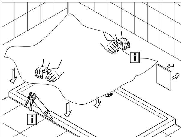
**8.** Прикрыть поддон плёнкой, во избежание повреждений, и окончить укладку плитки по периметру пола. Нанести силиконовый герметик между поддоном и полом, а также между поддоном и стеной.
