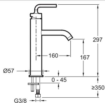
Спецификация продукта: Высокий смеситель для раковины. E14404-4A. Коллекция: PURIST. Вес: 3,4 кг. Расход воды: 7 л/мин при давлении 3 бар. Механизм: Последовательный керамический картридж.
