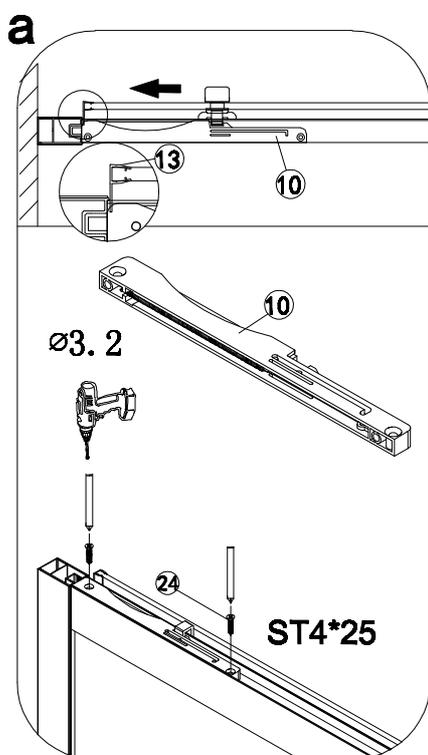
Первый поршень расположен в верхней части неподвижной стеклянной профильной рамы на стене и, как показано на рисунке.
