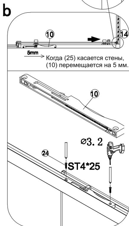
Как показано на рисунке, второй поршень расположен в верхней части неподвижной профильной рамы, расположенной напротив стены
