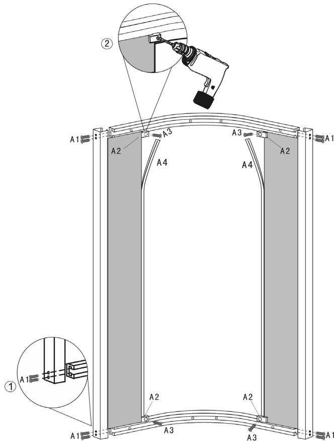
Когда рама собрана и Вы убедились, что неподвижные стекла становятся в раму, прикрепите раму к стене. Оденьте уплотнитель на ту сторону неподвижного стекла, которое вставляется в металлическую раму. Вставьте стекло в раму. Закрепите его при помощи уголков A2. Сделайте тоже самое со вторым стеклом.
