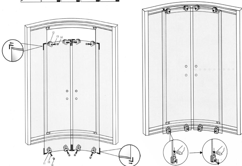
Поставьте Г-образные отсекатели на заднюю часть дверей и неподвижное стекло, чтобы вода не вытекала из изделия во время приема душа. Если у вас в комплекте идет 2 отсекателя, тогда они устанавливаются на неподвижное стекло.
