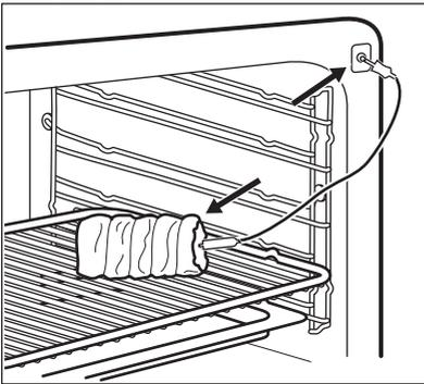
3. С помощью кнопок **+** или **-** задайте нужную температуру внутри продукта. Температуру можно задавать в диапазоне от 30°C до 99°C.
