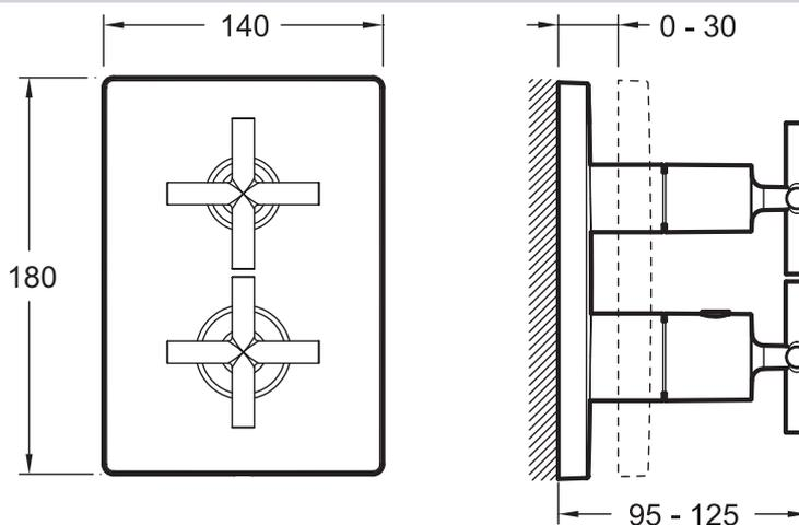
Спецификация продукта: Термостатический смеситель. E75395. Коллекция: MODULO. Вес: 2,9 кг. Тип установки: Встраиваемые. Термостатический смеситель с запорным краном. Металлические заглушки и ручки. Расход воды : 26 л/мин при давлении 3 бар. Устанавливается вместе с универсальной системой 98699D.
