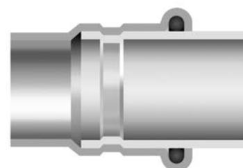
Соединение элементов по технологии „Press” позволяет свести к минимуму сужение сечения трубы, что значительно уменьшит потери давления во всей системе и создаст оптимальные гидравлические условия.
