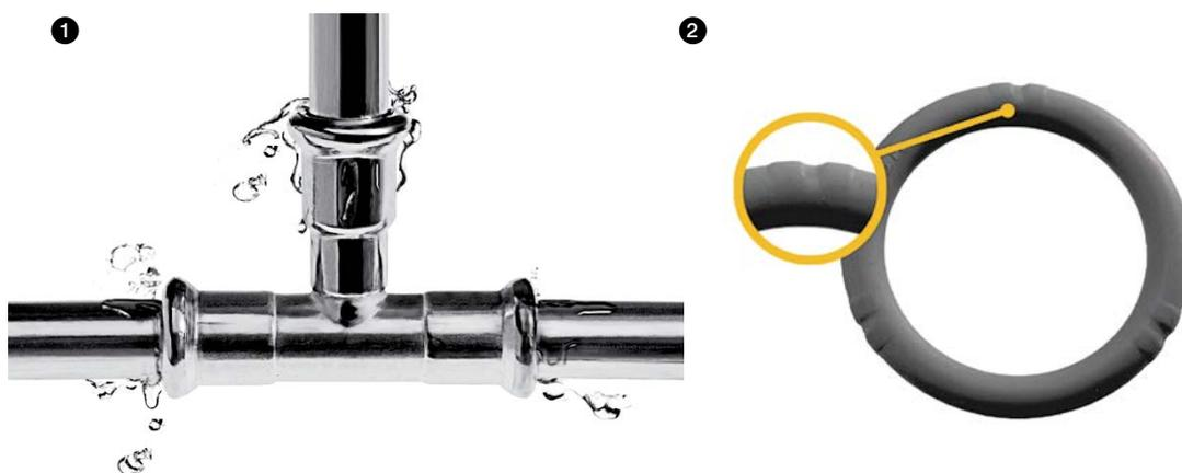
В диапазоне диаметров 15–54 мм, функция LBP реализуется за счет специальной конструкции уплотнительных прокладок типа O-Ring. Благодаря специальным желобкам O-Ring LBP обеспечивает оптимальный контроль соединений во время испытаний давлением.
