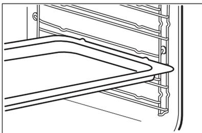
Одновременная установка решетки и глубокого противня:
