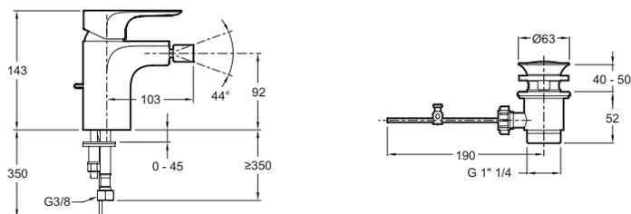
Спецификация продукта: Однорычажный смеситель для биде. E72279. Коллекция: ALEO. Вес: 2,1 кг. Расход воды: 5 л/мин. Высота под изливом: 143 мм. Механизм: Керамический картридж.
